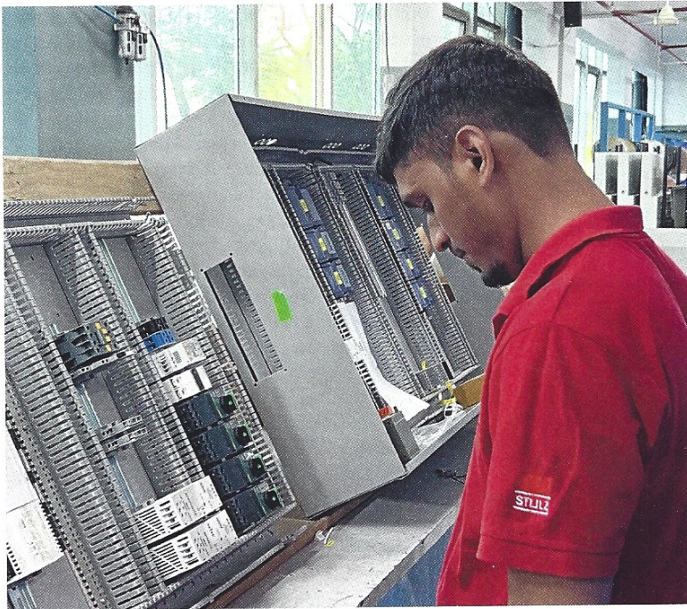
Montage in Mumbai: Ein Mitarbeiter des deutschen Kältetechnikunternehmens Stulz baut Steuerungskästen.
